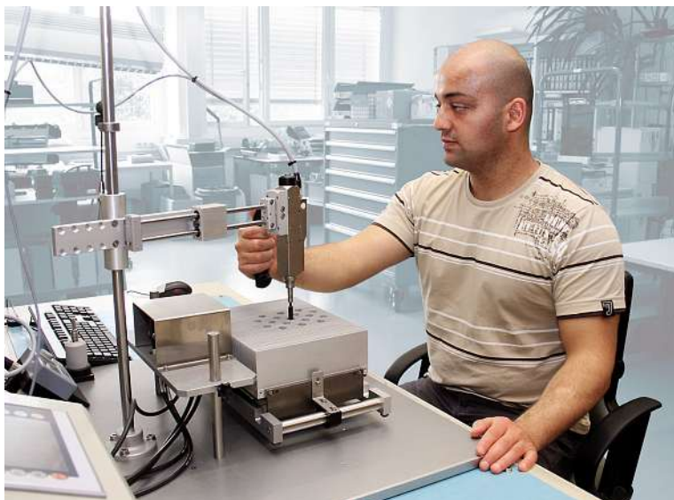
Bild 2: Um eine gleichmäßige Flächenpressung sicherzustellen, setzt Inheco zum Verschrauben der Thermal-Cycler-Baugruppen eine Mikro-Torque-Spindel ein.
